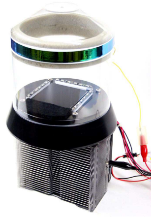
2019年9月から、観察面積を従来と同じSD型の4cm角から6cm角にまで拡大した、ペルチェ霧箱-EX型を販売致します。大型円筒形チャンバーと側面照射LEDの使用によって大勢での観察を可能としました。従来型やSD型よりも圧倒的に高性能な、上位機種となります。
