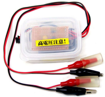
一台のATX電源と高電圧ユニットで、2台の本体を動作させることが出来、同時に \alpha 線と \beta 線を観察して比較できます。
