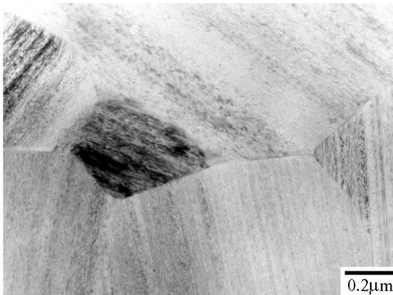
Fig. 4.3-14: 1000°C アニール後の T67 試料 (×40k, 412L)
