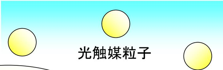
蛍光灯の光には400nm以下の波長の紫外光成分も含まれていましたが、一般的な可視光LEDは440nm程度をピークの青色LEDと黄色の蛍光体の組み合わせで出来ていて、400nm以下の紫外線は含まれていません。
