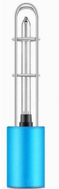
この製品はCCFL(冷陰極管)を使用した製品であり、熱陰極を利用した蛍光灯同様に水銀からの254nm殺菌線を出している。蛍光灯よりも水銀使用量が少ないとの事で現在でも製造が続けられている。12V電源などでインバータ回路を駆動するため、バッテリーでの利用も現実的で、左の写真のようなポータブルな製品も売られている(CCFL管の部分が100mm)。
