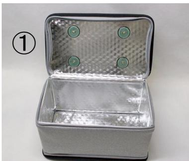
この製品は、BOX 底面中央では全く紫外線を検出できませんでした。LED にベタ付けで測定すると、UV-C 3mW/cm<sup>2</sup> 程度が測定されるが、実際にBOXに物品を入れて謳い文句の通り表面のウイルスを99.9% 不活化するとしたら、7.5mJ/cm<sup>2</sup> 必要であり、仮に0.001 mW/cm<sup>2</sup> としても7500秒ほどかかり、非現実的。
