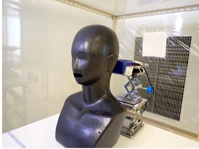
HEPA フィルターを使用した大型クリーンブース (1.5 × 1.5 × 2.4m)中に設置した実験レイアウト。
