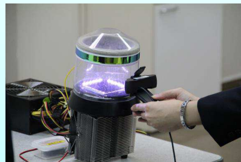
クルックス管からの低エネルギーX線をペルチェ霧箱EX型を用いて観察した。
