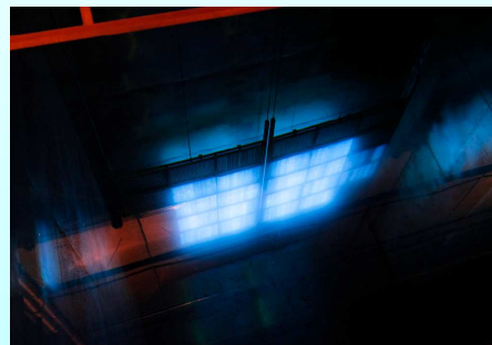
コーガアイトープ社の Co-60 ガンマ線源からのチェレンコフ光
