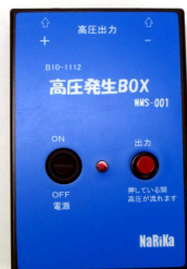
9V電池駆動の 5kV CW高圧電源
