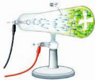
図41 十字板入り放電管と電子のモデル 一極側から出た電子が十字板に当たり、そのうしろに影をつくる。ガラス壁に衝突した電子は、+極側へ移動していく。
