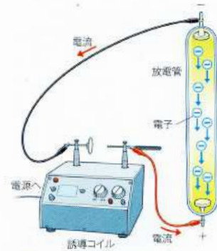
図42 放電管内の電子の移動
