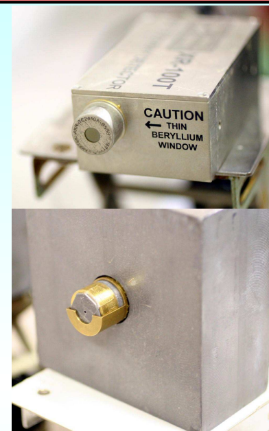
Amptek XR-100T-CZT CZT(Cd 0.9 Zn 0.1 Te)検出器 Be窓、ペルチェ冷却
