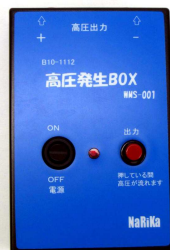
9V電池駆動の 5kV CW高圧電源
