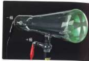
図19 陰極線の性質 金属板のかげが+極側に行けることから、陰 極線は一極から出ていることが確かめられる。
