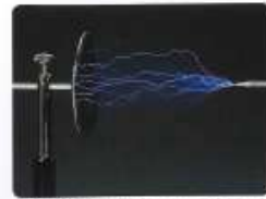
図15 誘導コイルで起こした放電のようす 誘導コイルを使うと、空気中を流れる電流の ようすを見ることができると。
