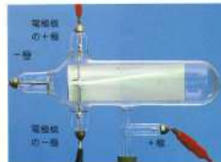
電圧をかけた電極板の間を通すと、電極板の+極のほうに曲がる。
