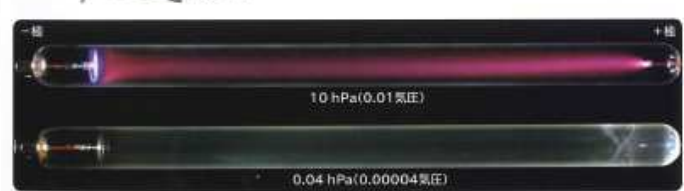
図18 真空放電のようす 放電管内の空気をぬいていき、空気がない状態である真空中に近づけると、全体が暗く黄色に光る。
