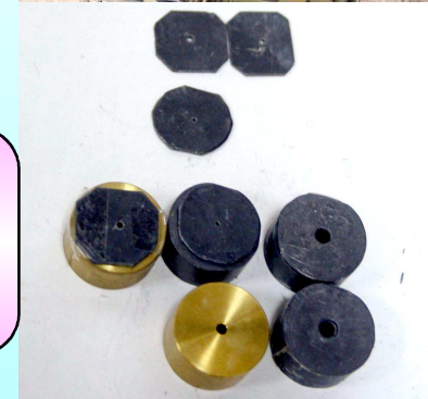
φ3同軸鉛コリメーター φ2同軸黄銅コリメーター φ1.0鉛薄板コリメーター φ0.5鉛薄板コリメーター
