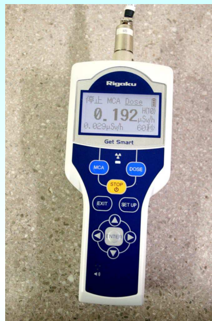
Rigaku Get Smart XU NaI シンチレーター 測定範囲 5~300keV (~10 μSv/h)
