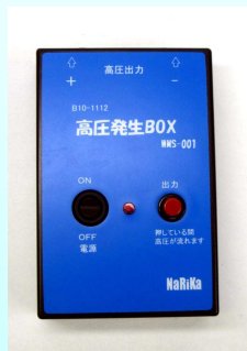
9V電池駆動の 5kV 高圧電源 (CW回路)
