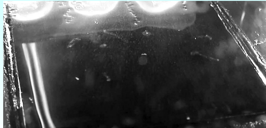
クルックス管からのX線によって弾き出された光電子の霧箱観察結果
