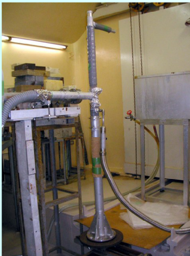
液体窒素温度での 低温照射ホルダー
