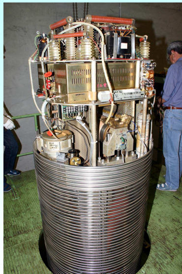
加速管上部のイオン源と 電場安定用フープ
