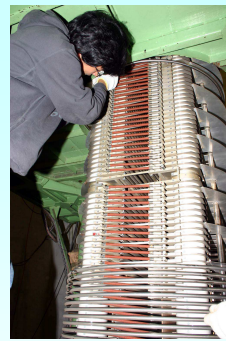
印加電圧均等配分の ための大抵抗素子
