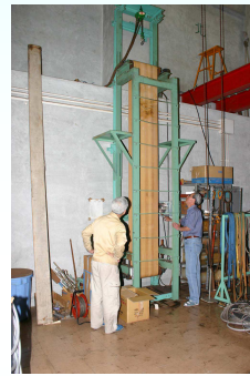
印加電圧均等配分の ための大抵抗素子
