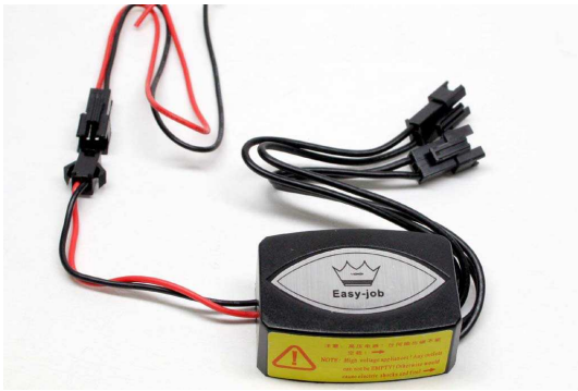
図 4: CCFL (冷陰極管) インバータと、同梱されている接続ケーブル。
