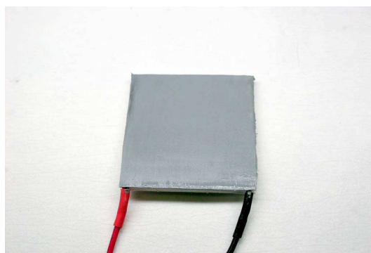
図 10: ペルチェ素子表面に均一にグリスを塗布した様子
