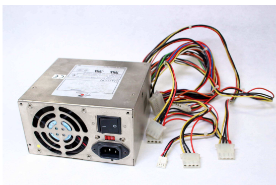
図 4: 一般的な ATX 電源の例。本体に電源スイッチが備えられていると使いやすい。
