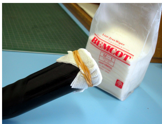
図 9: 掃除機のノズルの先に輪ゴムでベンコットを取り付けて、空気中のラドントロン娘核種を捕集している様子。
