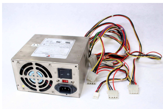
図 5: 一般的な ATX 電源の例。本体に電源スイッチが備えられていると使いやすい。
