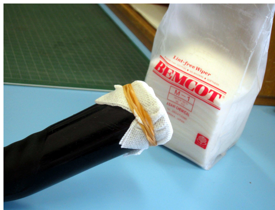
図 8: 掃除機のノズルの先に輪ゴムでベンコットを取り付けて、空気中のラドントロン娘核種を捕集している様子。
